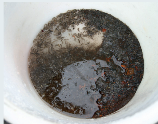
Bild 5: Rückstände (überwiegend Wasserasseln) aus einer INWERT®-CO 2 -Spülung
